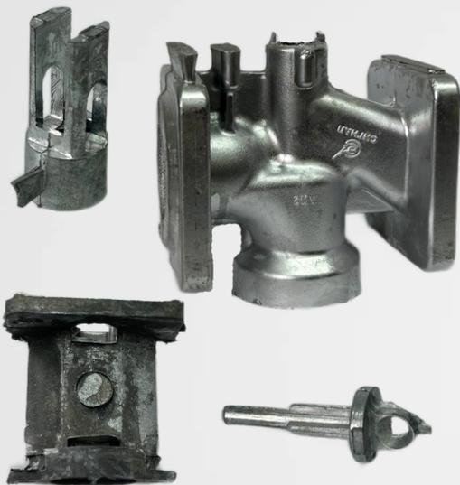
Вес получаемых отливок -от 1кг до 25 кг с использованием многоразовых форм и песчаных стержней для оформления внутренних поверхностей.
